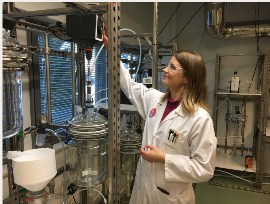
Kuva: Siiri Perämäki on valmistanut jätemagneeteista puhdasta neodyymituotetta, jonka tutkimista tullaan jatkamaan kuvan pilot-laitteistolla.
