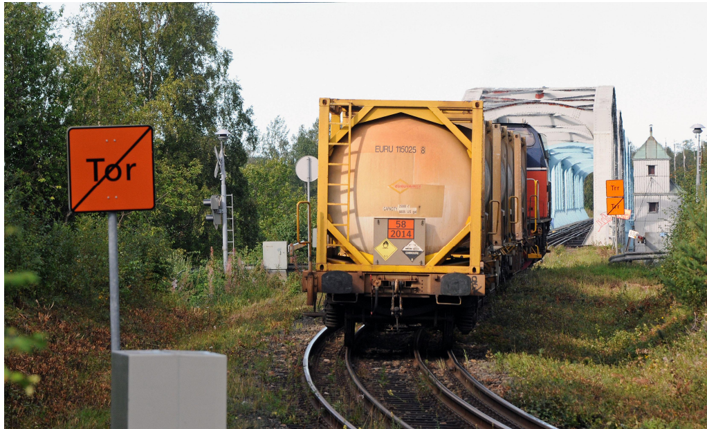
Kuva 9. Ruotsalainen juna matkalla Tornionista Haaparantaan. Maiden välillä on kahden eri raidelevyden, 1435 mm ja 1524 mm, raiteet samassa tilassa.
