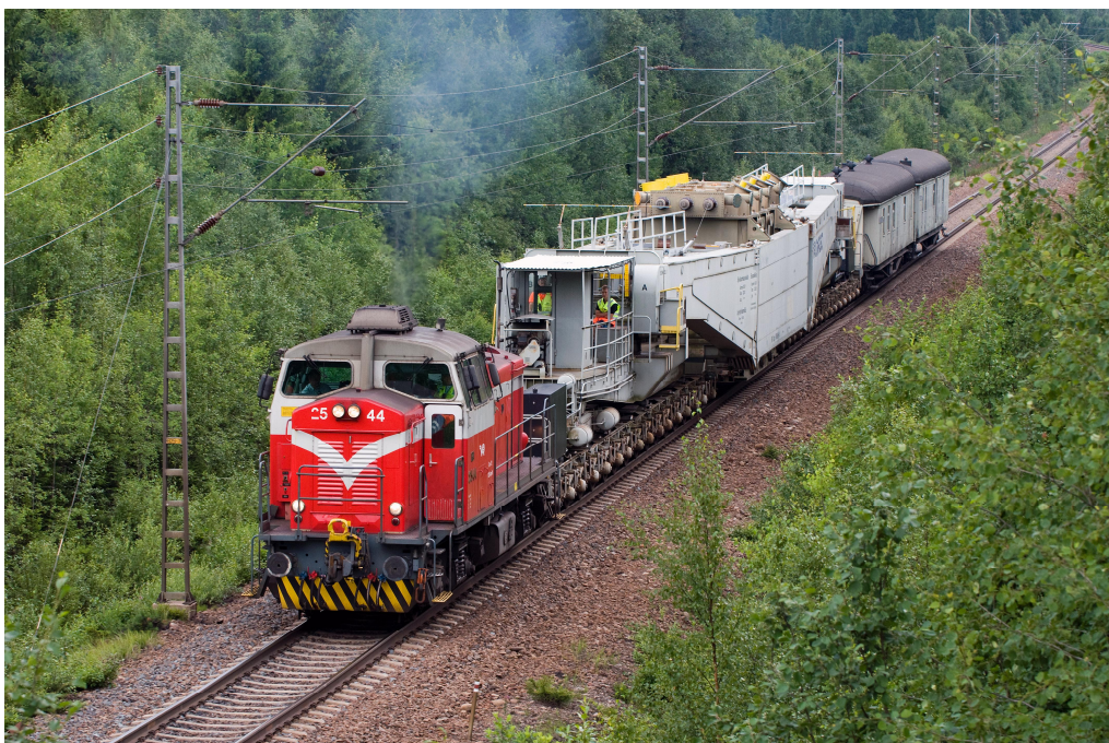
Kuva 11. Suurkuormavaunu kuormattuna 400 kV muuntajalla.
