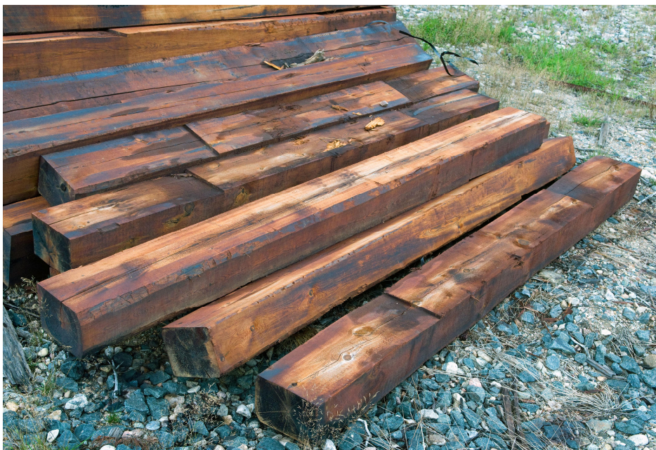
Kuva 4. Puisia kreosootilla kyllästettyjä ratapölkkyjä odottamassa asennusta rataan.
